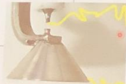
傘型電極 (特許出願中) (サイクル間の流れ方向のゆらぎに対応)
